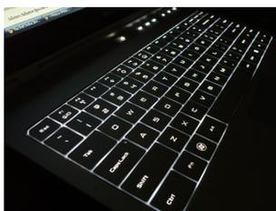
המקלדות בעלות התאורה האחורית במחשבים הניידים של Dell מאפשרות מצבי תאורה שונים. הקש <Fn> ומקש חץ ימינה כדי לעבור בין מספר מצבי תאורה. **הערה:** ייתכן שלא בכל המחשבים תהיה תמיכה בתאורה אחורית. כדי לבדוק אם מקלדת מוראת זמינה עבור המחשב שלך, ראה את מפרט המחשב באתר [dell.com/support](http://dell.com/support).
